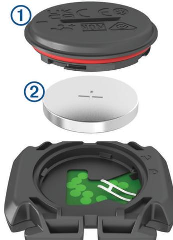
2 Drehen Sie die Abdeckung entgegen dem Uhrzeigersinn, bis die Markierung auf die entsperrte Position zeigt und sich die Abdeckung abnehmen lässt.
