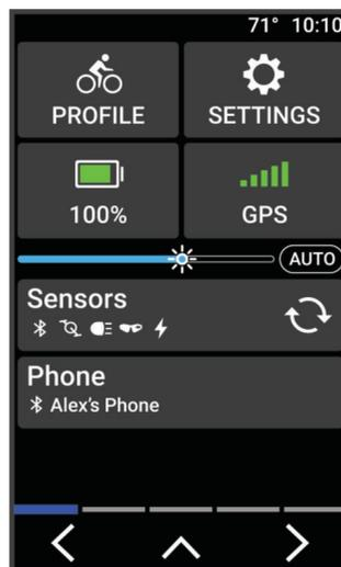
Das Einstellungs-Widget wird angezeigt. Wenn ein Icon blinkt, sucht das Gerät ein Signal. Wenn ein Symbol leuchtet, wurde das Signal gefunden oder der Sensor ist verbunden. Sie können ein beliebiges Symbol auswählen, um die Einstellungen zu ändern.
