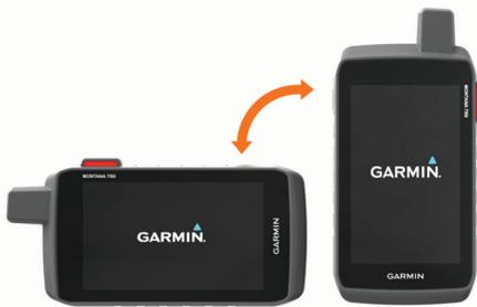
**HINWEIS:** Wenn Sie die inReach Funktionen des Montana 700i/750i Geräts nutzen, sollten Sie das Gerät im vertikalen Modus (Hochformat) verwenden, wobei die Antenne auf den Himmel ausgerichtet ist.
