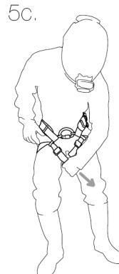
**Adjusting the leg loops / Réglage des cuisses**
