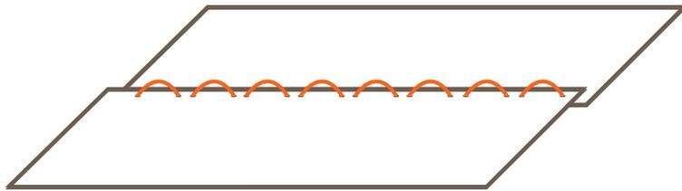
An der Nahtstelle werden beide Materialschichten perforiert, zum Nachteil der Wasserdichtigkeit. Unter widrigen Bedingungen besteht die Möglichkeit, dass Feuchtigkeit ins Innere dringt.
